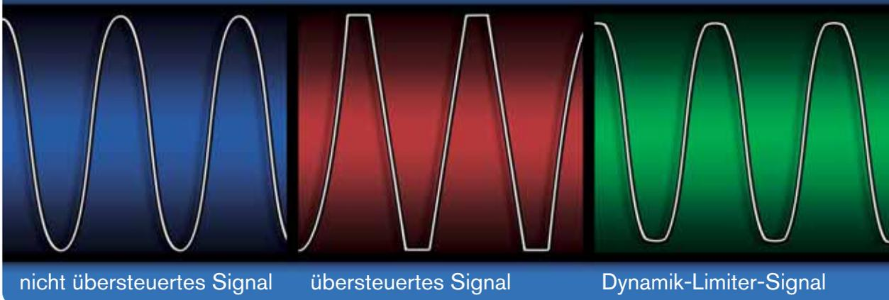
Maximales Ausgangssignal - Eingangssignal bei Eingangsempfindlichkeit, THD <math>\leq 0.1\%</math>
